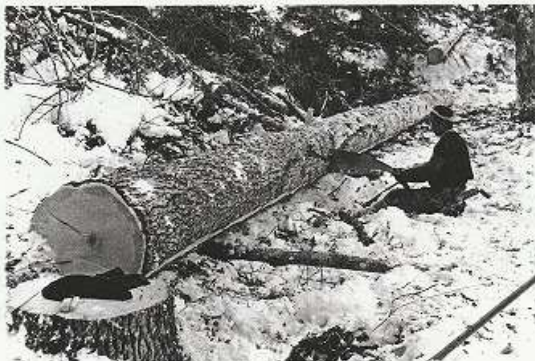
定尺に切断。細い部分は反割ぎ後に切断する
